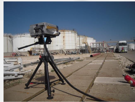
Figure 2 : Caméra hyperspectrale en fonctionnement sur le site industriel.
