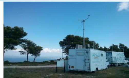
Prélèvements in-situ d'aérosols en sortie de cheminée et au sol dans l'environnement proche de la source : **analyse des types, taille, concentrations, des aérosols de fond et du panache.**
