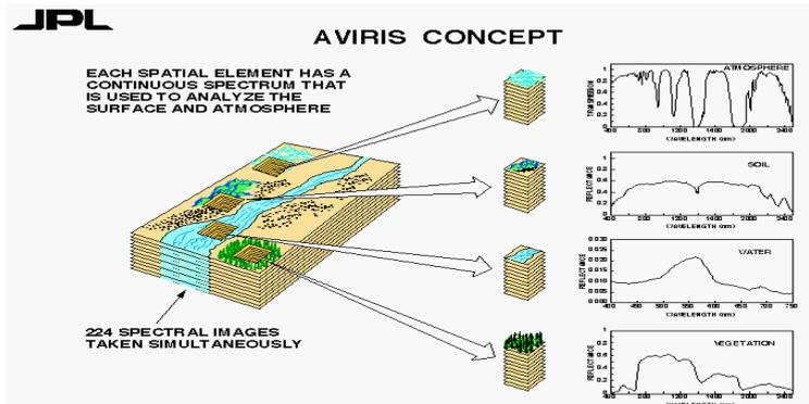
Figure : principe de l'imagerie hyperspectrale.
