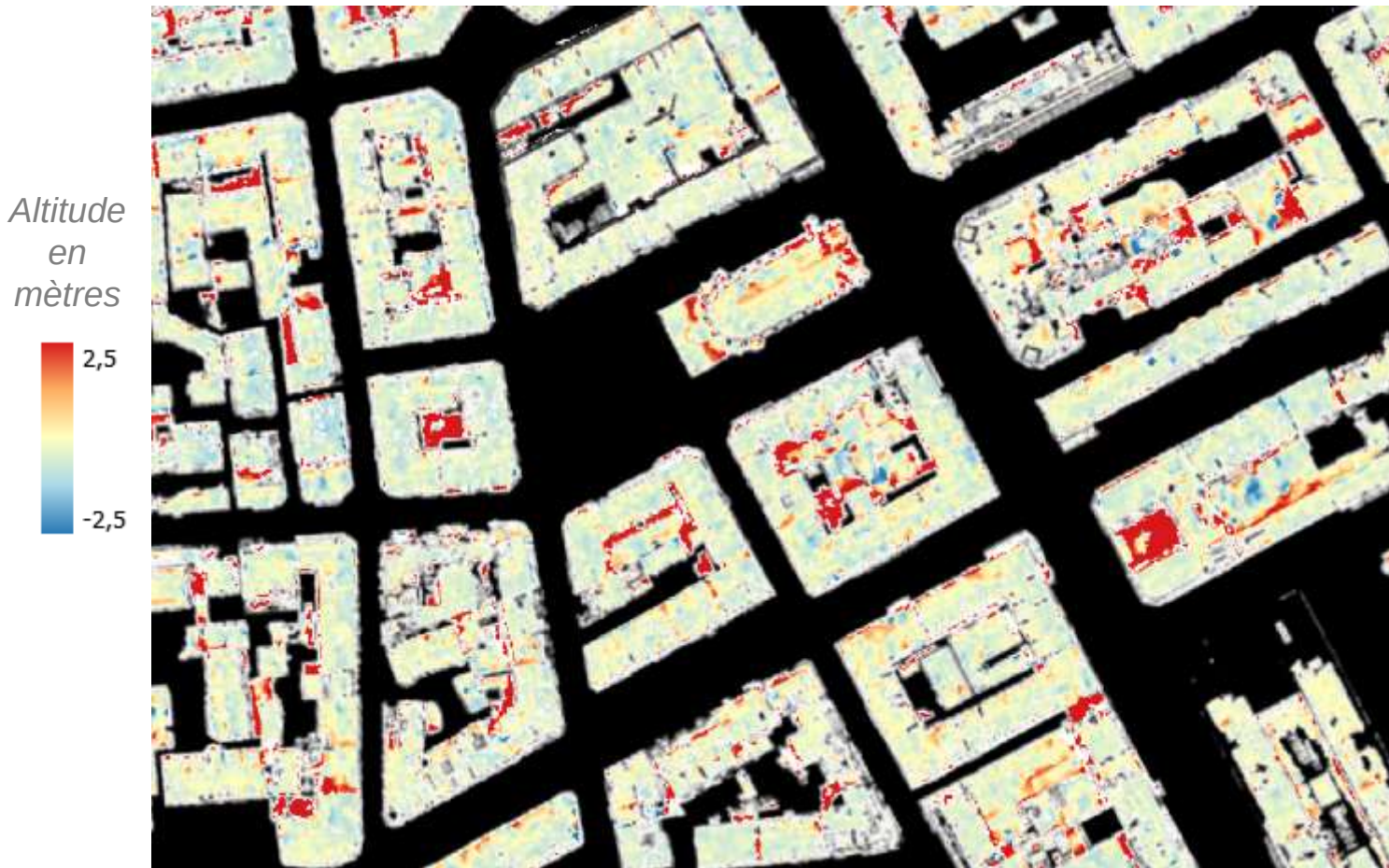
Différence MNS PNEO stéréo / Lidar HD
