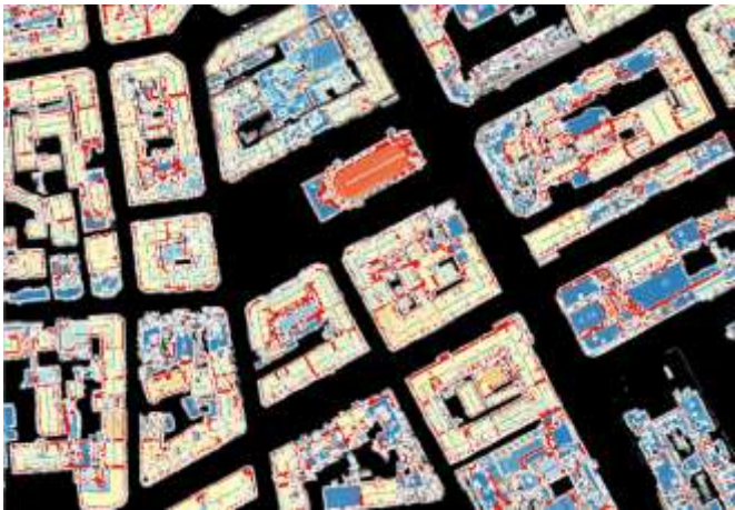
Lidar HD colorisé en fonction de la pente
